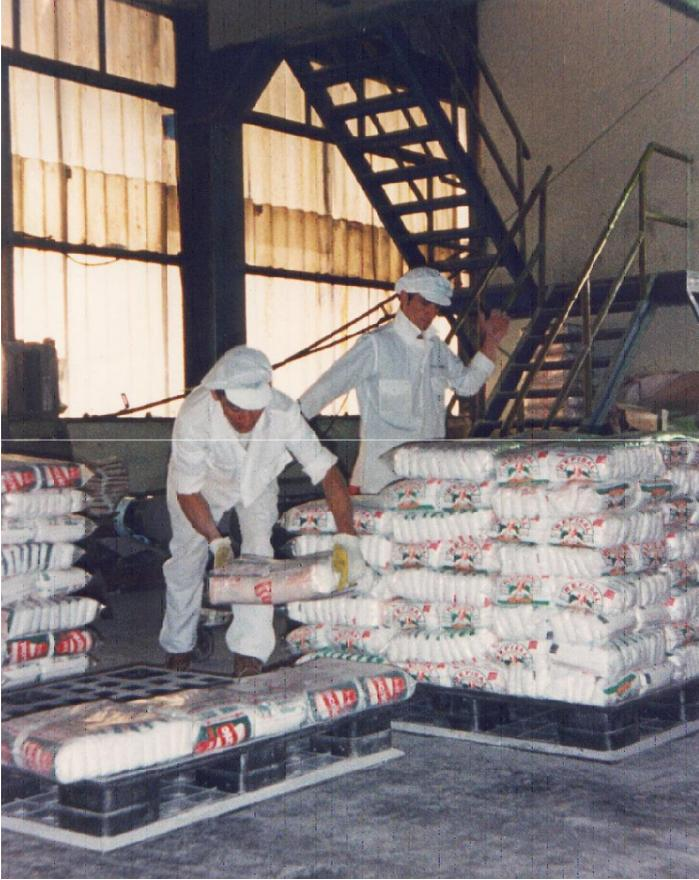
Paleta extrafuerte para trabajos pesados, se maneja solo con montacarga salvo necesidad expresa del cliente que requiera utilizar zorra. Su diseño de cuatro entradas facilita las maniobras de operación.
